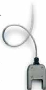
Die SET/S2 Schlammalarmsonde wird im unteren Bereich des Abscheiders installiert. Die Sonde gibt einen Alarm aus, wenn die Schlammschicht die Sonde erreicht. Die Sonde ist normalerweise in Wasser getaucht.
