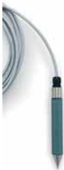
Die SET/DM3DL Ölkontaktsonde wird im Leichtflüssigkeitsspeicher in einer bestimmten Höhe installiert (siehe die technischen Zeichnungen des Abscheiderherstellers). Die Sonde gibt einen Alarm aus, wenn der obere Bereich der Sonde mit Öl in Kontakt kommt. Die Sonde ist normalerweise in Wasser getaucht.
