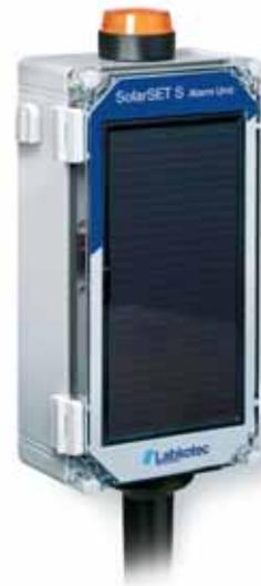
Das SolarSET Beacon signalisiert mit einer Xenon-Blinkleuchte einen Öl-, Schlamm- bzw. Pegelüberschreitungsalarm oder einen Sondendefekt. Die Leuchte blinkt alle 5 Sekunden, bis die Alarmbedingung beseitigt wurde.
